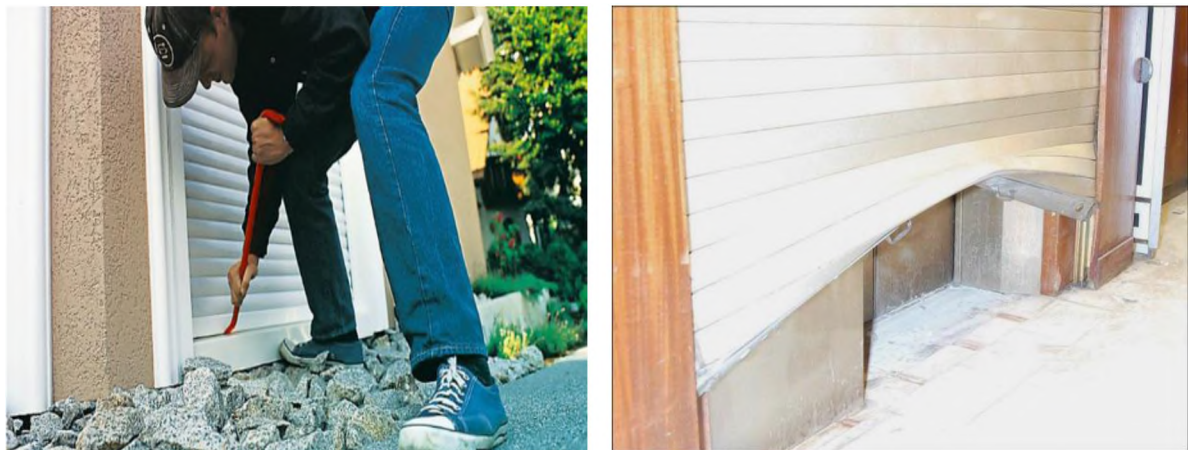
Рисунок 16 – Принудительный подъем полотна и его результат
