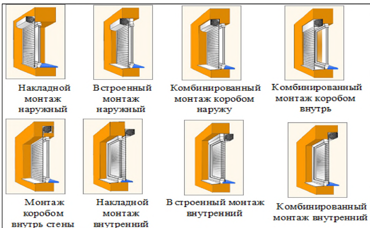
Рисунок 6 – Варианты монтажа рольставней
