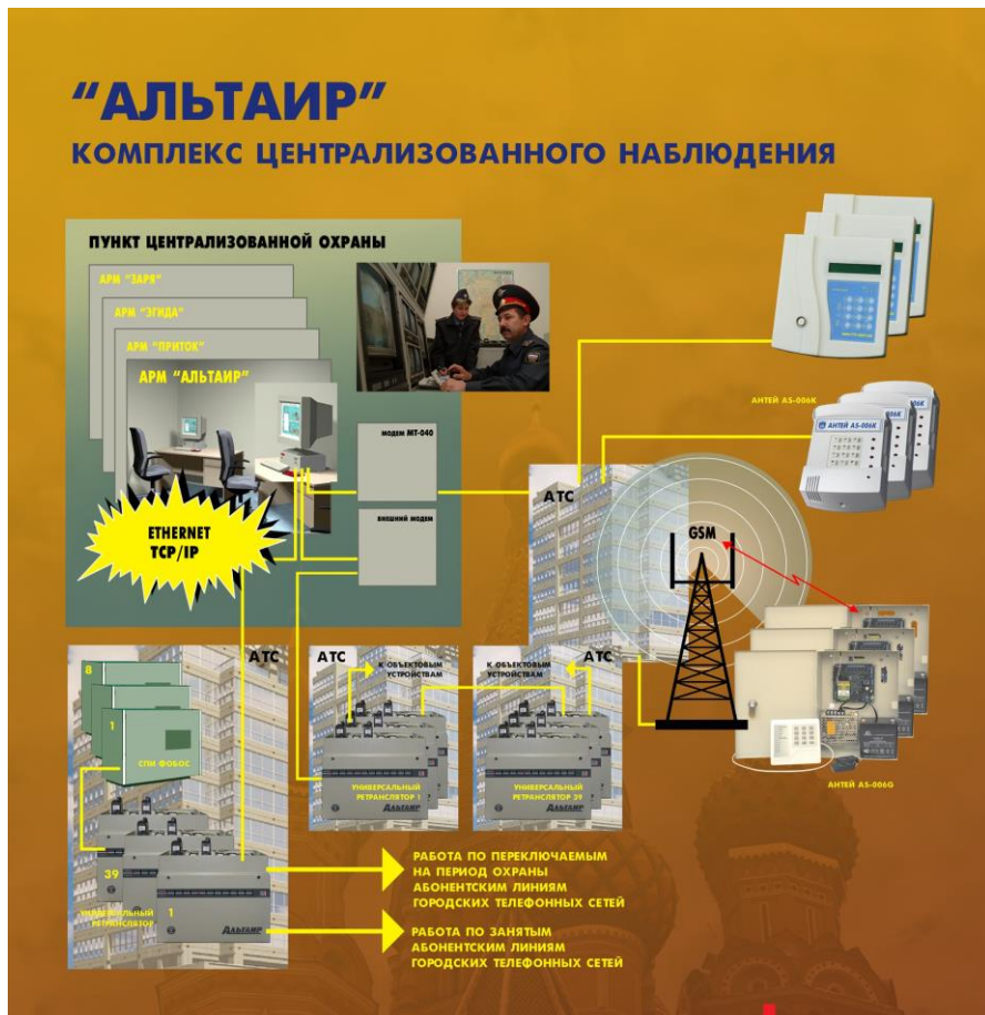
Рис. 1 - Вариант структурного построения комплекса централизованного наблюдения охранно-пожарного КЦНОП049-2/2/240/7680-1 «Альтаир».
